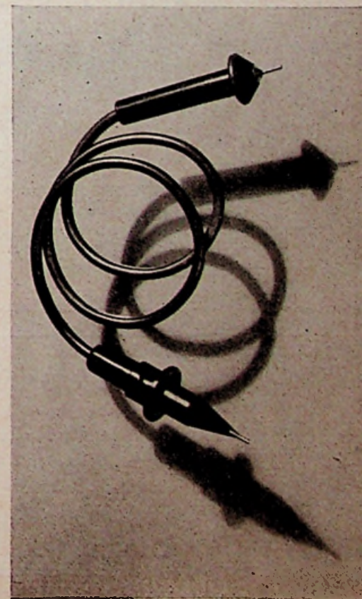
Philips spanningzoeker. Voor gebruik bij een netspanning voor wisselstroom min. 80 V, max. 750 V. Voor gelijkstroom min. 100 V, max. 750 V.
